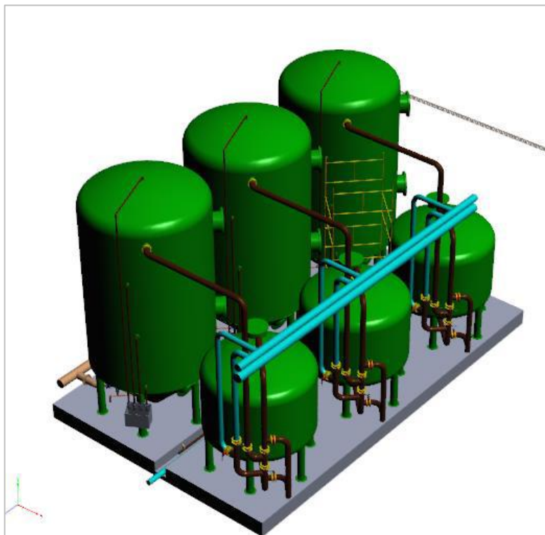
Figura 9 – Representação esquemática – ETA compacta fechada.
